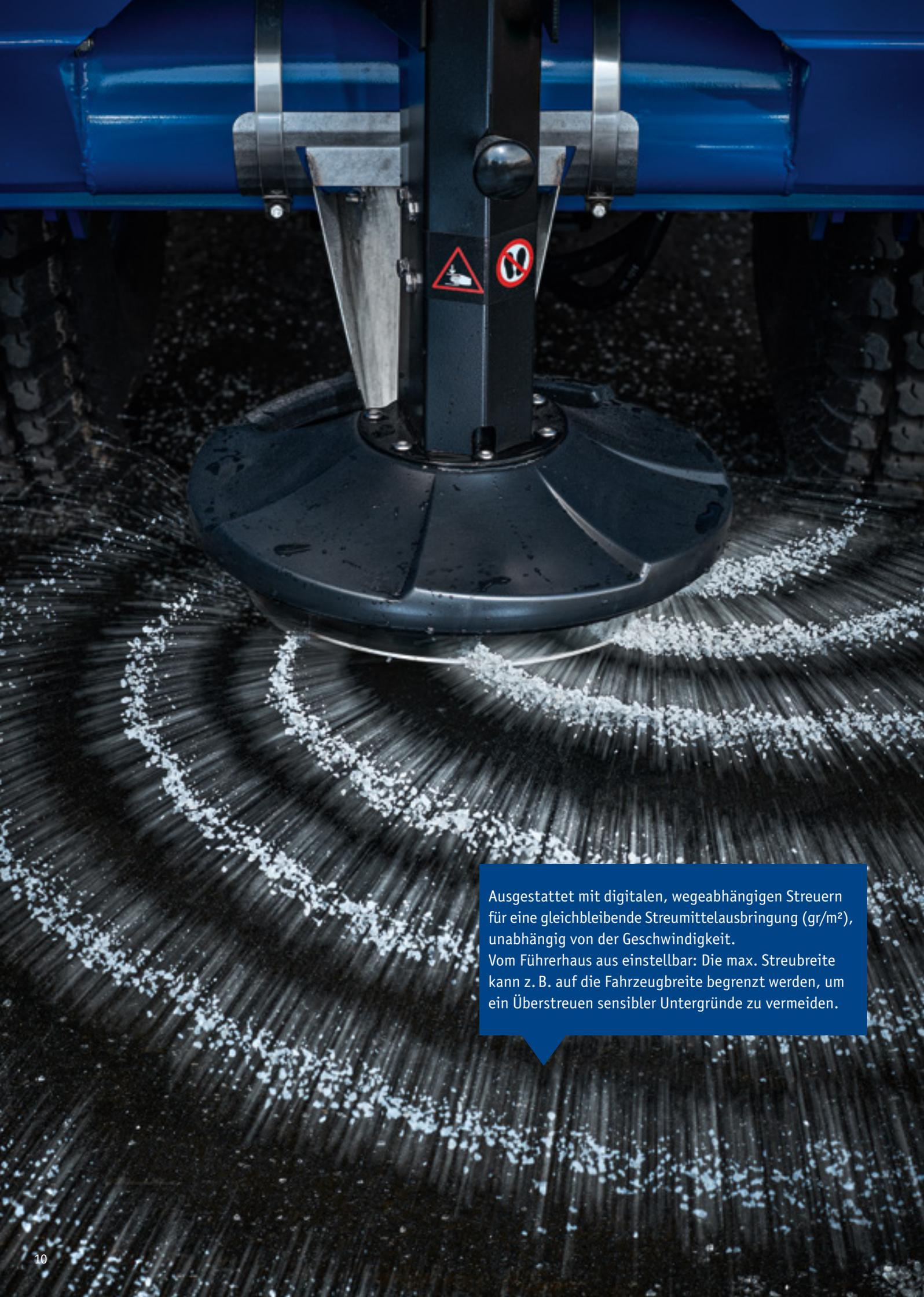
Ausgestattet mit digitalen, wegeabhängigen Streuern für eine gleichbleibende Streumittelausbringung ( $\text{gr}/\text{m}^2$ ), unabhängig von der Geschwindigkeit. Vom Führerhaus aus einstellbar: Die max. Streubreite kann z. B. auf die Fahrzeugbreite begrenzt werden, um ein Überstreuen sensibler Untergründe zu vermeiden.
