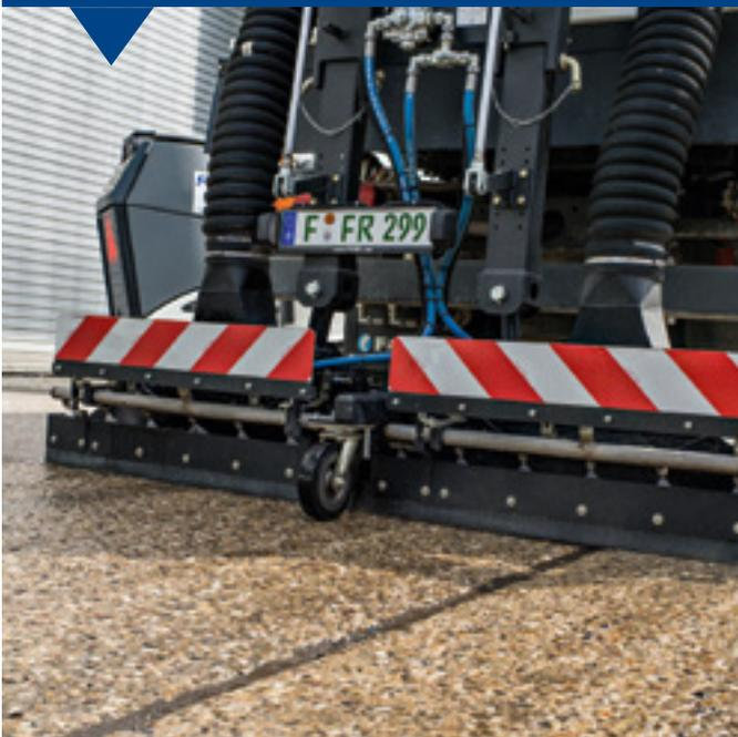
Großkehrmaschine mit Hochdruck-Hecksauganlage
